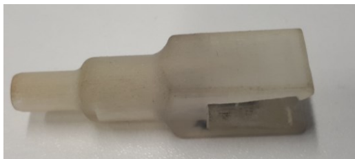
Obr. 4.13 A vzorek klipu, který slouží k ověření sestavitelnosti a první indikaci funkce klipu
