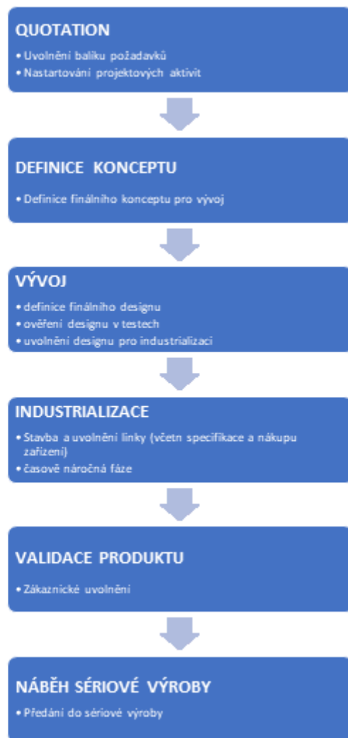
Obr. 14.5 Fázový vývojový proces – příklad 3
