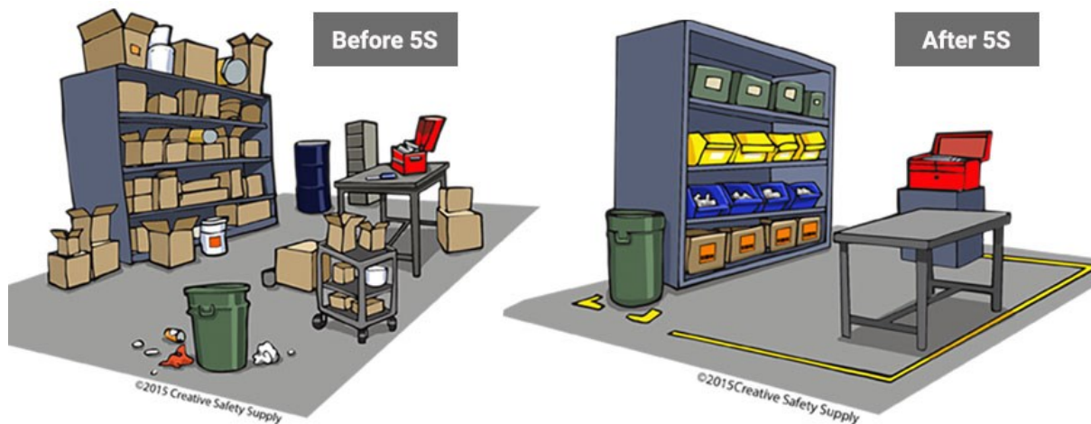
Obr. 13.5 Ukázka pracoviště podle 5S před aplikací (vlevo) a po ní (vpravo) [13.4]
