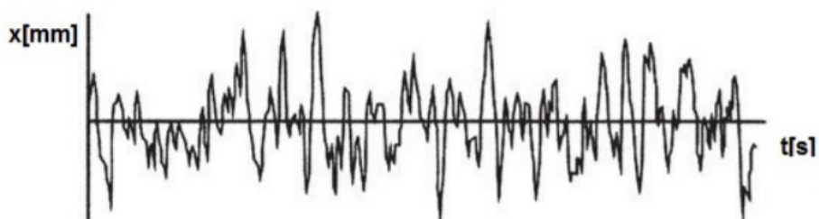
Obr. 10.6 Příklad stacionárního náhodného vibračního signálu [10.2]
